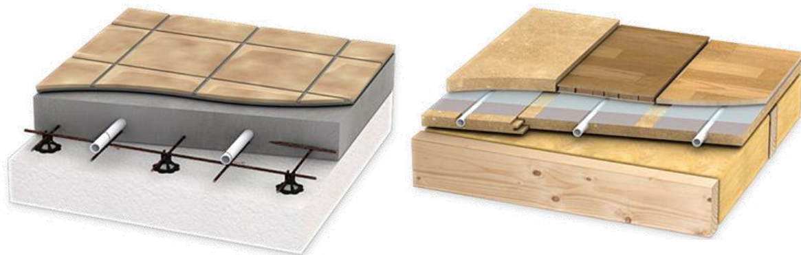
Figur 17 Illustration av golvvärmesystem. Till vänster ett system ingjutet i en platta på mark av betong. Till höger ett lätt system med frästa spånskivor och värmefördelningsplåtar i aluminium för träbjälklag. (Med tillstånd av Uponor)
